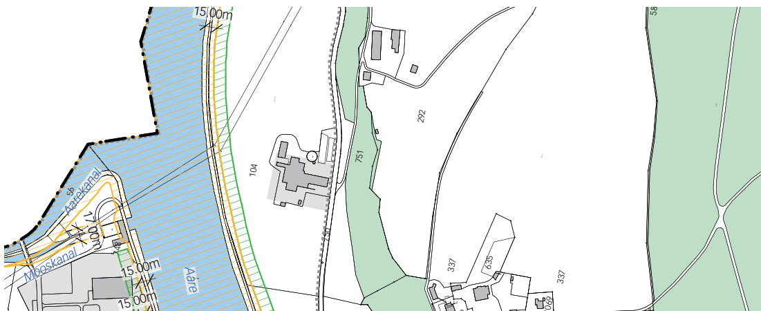
Abb. 21 Gewässerräume der Aare, des Aarekanals und des Mooskanals: Gewässerbreite plus 15.0 m ab Uferlinie (orange schraffiert) plus ein Freihaltebereich von 15.0 m ausserhalb der Bauzone (grün schraffiert).
